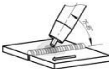
Рис. 8.5. Угол наклона горелки.
