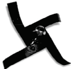
Дополнительная фреза необходима для увеличения ширины вспахивания
