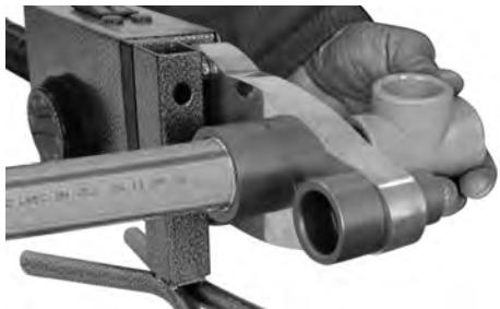
По окончании предписанного времени нагревания, быстро снимите пластиковую трубу и фитинг с насадок, и, сразу, не поворачивая их, сдвиньте друг с другом так, чтобы отмеченная глубина сварки была покрыта образующимся наплывом.
