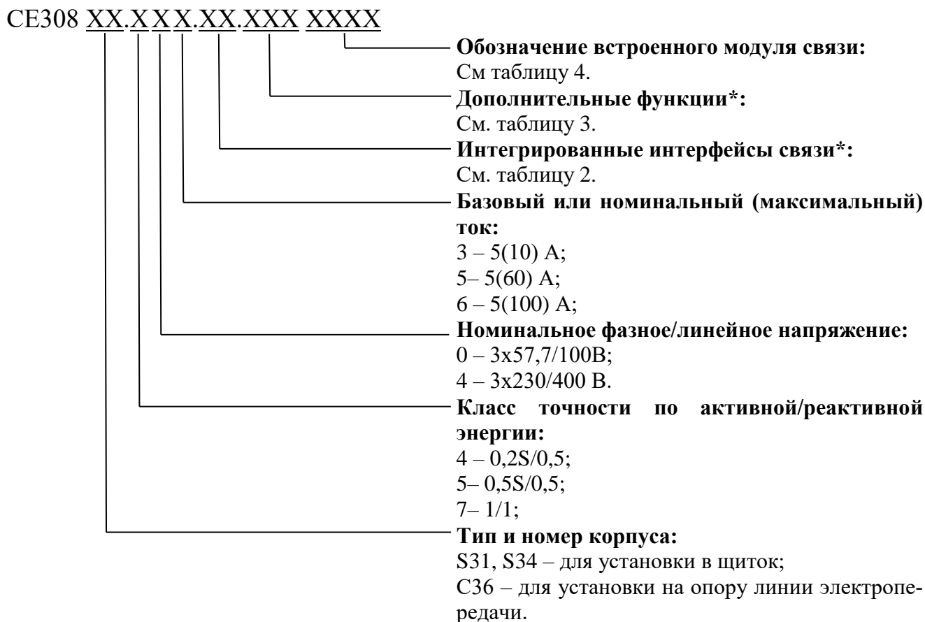
Рисунок 2 – Структура условного обозначения СЕ308
