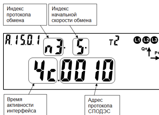
Рисунок 28 – Настройки оптического интерфейса связи по протоколу СПОДЭС
