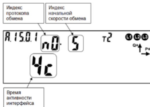
Рисунок 26 – Настройки оптического интерфейса связи с протоколом «Авто»
