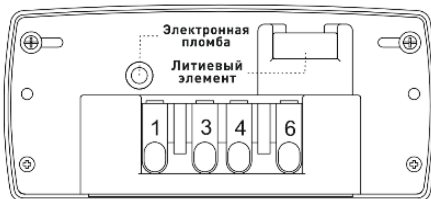
а) – первый вариант обозначения контактов зажимов счетчика СЕ208 С4
