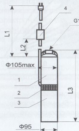
Рис. 1 Габаритные и присоединительные размеры
