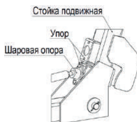
Рис. 5. Установка шаровой опоры
