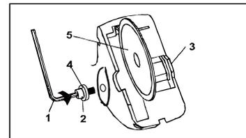
**ВНИМАНИЕ!** Эта модель пилы может использовать диск  $\phi 125\text{mm}/\phi 120\text{mm}/\phi 115\text{mm}$ , если толщина диска более большое чем 1.3 мм, использование пильного диска становится небезопасным из-за невозможности плотно зафиксировать его на фланце
