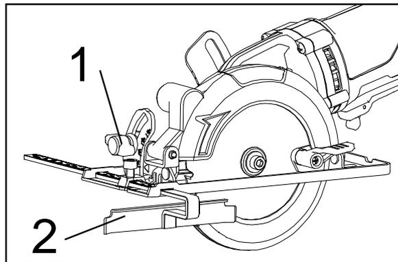
**ВНИМАНИЕ!** Положение линии разреза лезвия изменится в зависимости от угла наклона, который используется. Расположение линии разреза лезвия при резке под углом 90 градусов или 45 градусов обозначается выемкой на передней части опорной плиты. Опорную плиту необходимо всегда держать твердо против отрезаемого материала для уменьшения вибрации пилы, скачка диска, или его разрушения.
