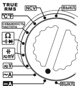
**Примечание:** При измерении тока можно зажать только один провод. Зажав несколько проводов, измерение провести невозможно.
