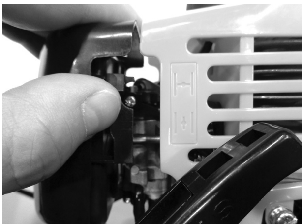
Рис. 4 Рычаг управления воздушной заслонкой в положении «ЗАКРЫТО»
