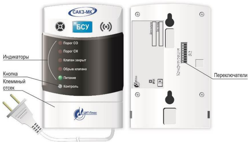
Рисунок 8 – Внешний вид блока БСУ.
