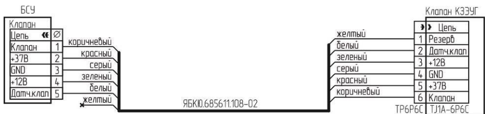
Рисунок Б.8 – Схема подключения клапана КЗЭУГ с разъемом Т11А-6Р6С.
