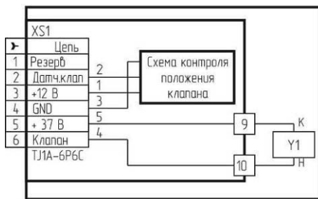
а) с разъемом типа TJ1A-6P6C
