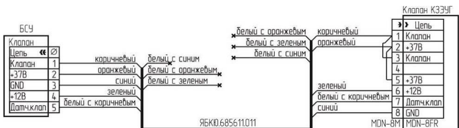
Рисунок Б.7 – Схема подключения клапана КЗЭУГ с разъемом MDN-8FR.
