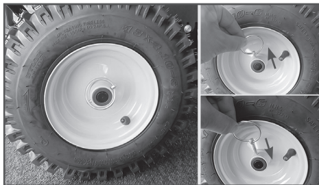
Рис.10 Привод на одно колесо
