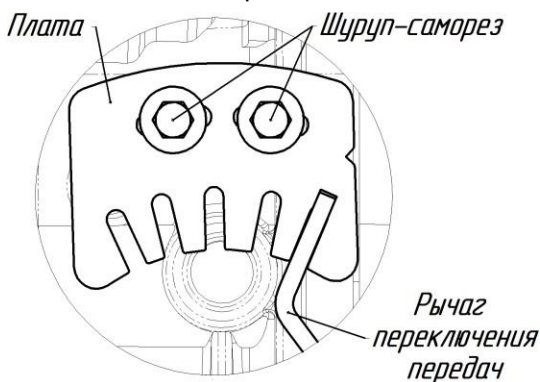
Рис.12. Настройка узла переключения передач
