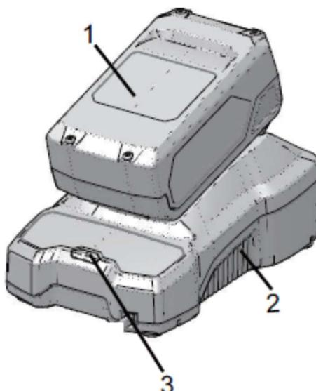
Это диагностическое зарядное устройство. Светодиодные индикаторы зарядного устройства (3) будут гореть в определенном порядке, чтобы показать текущее состояние аккумулятора. Индикаторы имеют следующие состояния:
