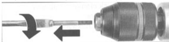
Выкрутите предохранительный винт. Внимание левая резьба!
