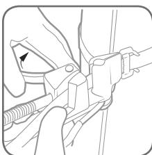
Отведите прижимной рычаг и установите инструмент до упора в бугель так, чтобы лента прошла через направляющие пазы. Затем отпустите прижимной нож для фиксации ленты в инструменте.
