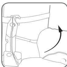
Потяните ручку отрезного ножа, чтобы разрезать ленту.
