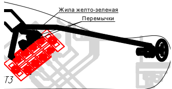
Рис.5 Схема подключения к однофазной сети. ЭВГМ-4,8...9.
