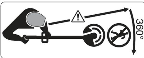
Varmista, että sivulle sinkoutuvat vieraat esineet eivät loukkaa lähellä seisovia ihmisiä.
