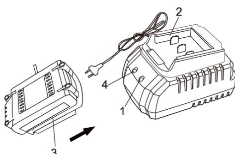
**ВНИМАНИЕ!** Чтобы сохранить работоспособность Li-ion батареи она не должна заряжаться при температуре ниже 0° С или выше 45° С. Если температура аккумуляторной батареи выше 45° или ниже 0° С, процесс заряда батареи не произойдет. При этом индикатор (1) будет гореть зеленым после подключения зарядного устройства к батарее. Если аккумуляторная батарея повреждена, процесс заряда батареи не произойдет. При этом индикатор (1) будет гореть зеленым после подключения зарядного устройства к батарее.
