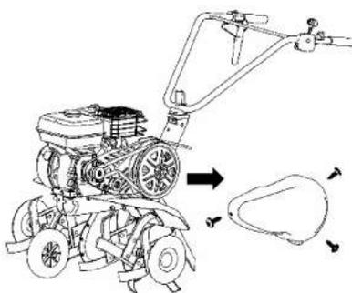
1- Снимите 3 стопорных винта с крышки ремня
