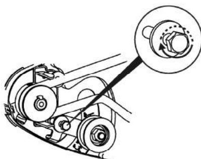
3- Отверните стопорный винт с рычага сцепления (на 2 оборота)
