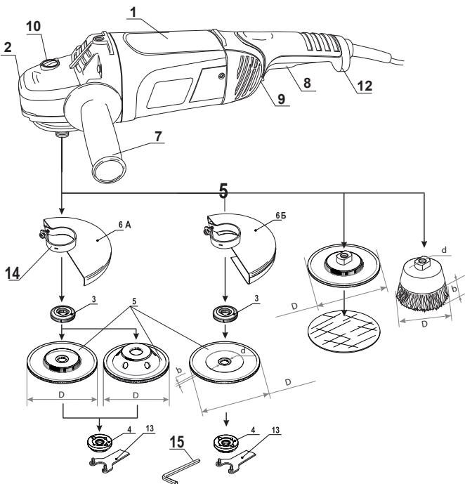
D - Номинальный Ø диаметр рабочего инструмента;
