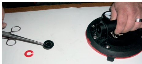
3. Вынимаем прокладку (арт. 6815011), протираем силиконовым спреем.
