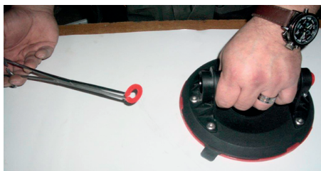
2. Вынимаем стопорное кольцо (арт.6815012), протираем силиконовым спреем.
