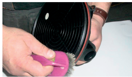
6. Очищаем мягкой щеткой рабочую поверхность присоски.
