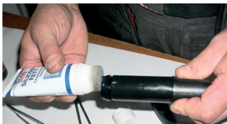
5. Смазываем силиконовой мазью уплотнитель поршня (арт. 6815019).
