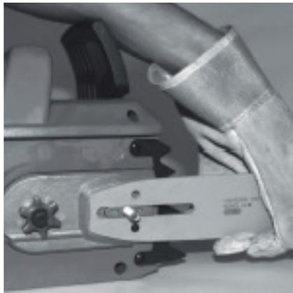
Время от времени переворачивайте полотно шины. Это позволит равномерно распределять износ полотна. Регулярно проверяйте смазочные отверстия полотна, в случае загрязнения их необходимо прочистить, иначе загрязненные отверстия могут стать причиной перегрева, раннего износа и поломки шины, пильной цепи и ведущей звездочки.
