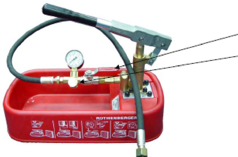
Ручной опрессовочный насос PR 30 для точной и быстрой проверки давления, а также герметичности трубопроводных систем и резервуаров в водопроводных, отопительных и сантехнических системах, в системах сжатого воздуха, паровых, в системах сжатого воздуха, паровых, охлаждающих и масляных установках, для котельных и при строительстве напорных резервуаров, идеален для заполнения солнечных батарей.
