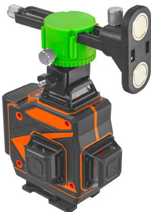
Для крепления на стене предусмотрен магнитный кронштейн. Он может устанавливаться на ферромагнитные поверхности. В условиях с отсутствующими металлическими конструкциями кронштейн можно закрепить на стене при помощи металлической пластины. Для этого возьмите пластину из комплекта поставки и закрепите её на стене, а уже на неё закрепите магнитный кронштейн.
