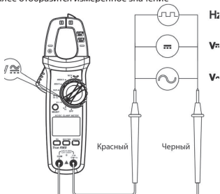
Рис. 3 Измерение напряжения переменного/постоянного тока и частоты
