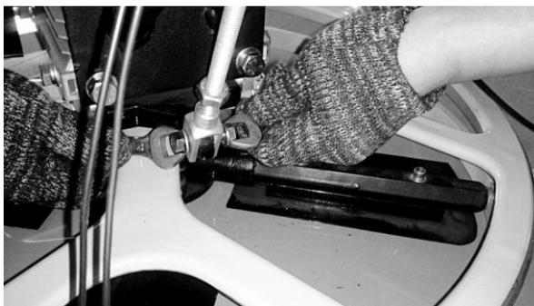
5. Снимите воздушный фильтр, чтобы закрепить трос, а затем снова установите воздушный фильтр.
