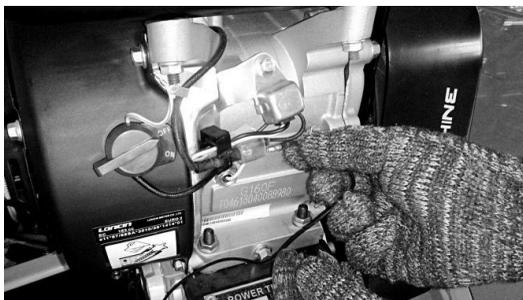
8. Закрепите соединительный винт ручки и обвяжите все кабели стяжным хомутом.
