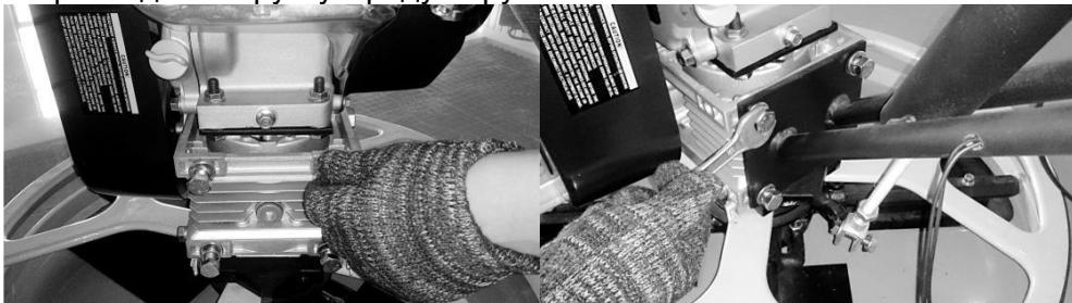
4. Снимите болты с регулировочного троса, подсоедините трос к рычагу регулировки угла наклона лопастей и закрепите болты.
