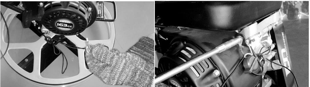
7. При помощи штекера закрепите провод останова двигателя (вместе с проводом от трубы рукоятки) к двигателю.
