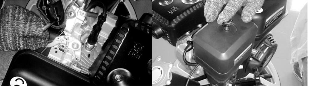
6. Закрепите провод выключателя остановки двигателя (от трубы ручки) на двигателе.
