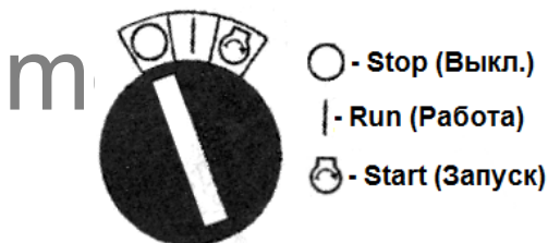
Рис.13. Замок зажигания (электростартер). Ключ в положении "O" (Выкл.).
