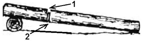
Рис. 11. Пропилы при раскряжевке дерева на одной опоре
