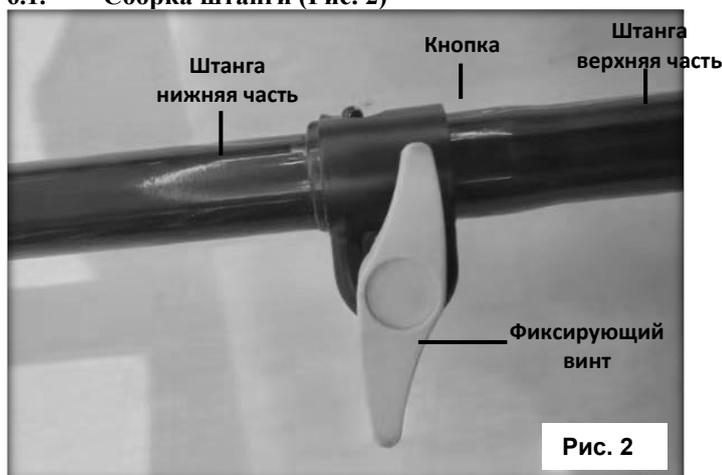
Штанга триммера состоит из верхней части, на которой располагается непосредственно двигатель, и нижней части, где расположены режущая головка с леской и защитный кожух.
