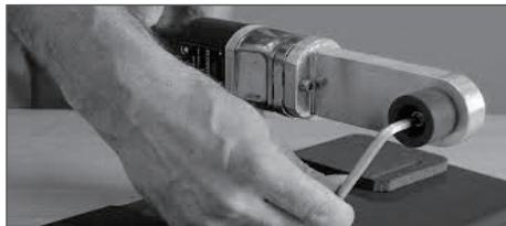
6.1.3 При помощи шестигранного ключа зафиксируйте насадки на нагревательном элементе. Убедитесь, что насадки всей поверхностью плотно прилегают к нагревательному элементу.
