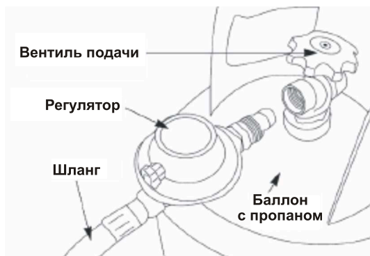
Рис 2. Подключение шланга с регулятором к газовому баллону
