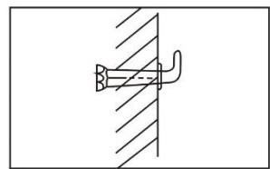
**Внимание!** Конструкция стены должна выдерживать двойную массу водонагревателя, наполненного водой.
