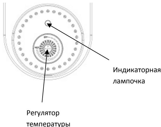
С помощью регулятора температуры установите необходимую вам температуру нагрева воды. Диапазон установки температуры от 30 до 75°C. Загорается индикатор работы, и водонагреватель начинает работать.
