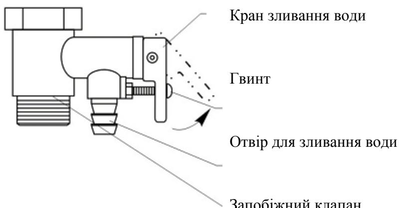
Щоб уникнути поломки при загвинчуванні запобіжного клапана не застосовуйте великих зусиль.
