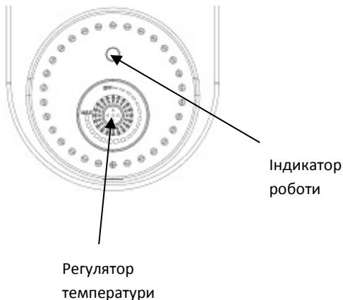
За допомогою регулятора температури встановіть необхідну вам температуру нагрівання води. Діапазон налаштування температури від 30 до 75°C. Засвітиться індикатор роботи, і водонагрівач починає працювати.
