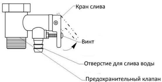
**Внимание!** Между входным патрубком водонагревателя и предохранительным клапаном должно обеспечиваться соединение с постоянным полным проходом. Установка запорной арматуры (краны, вентили и т.п.) на этом участке не допускается!
