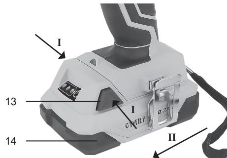
6.2.4 Отсоедините аккумулятор (14) от электроинструмента путем нажатия фиксатором (13) с обеих сторон и установите его в зарядное устройство.
