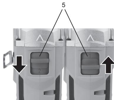
1 – скорость с низкими оборотами двигателями и возможностью достижения максимального крутящего момента для выполнения тяжелых работ.
