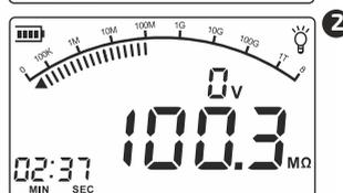
Не прикасайтесь к открытым токоведущим проводникам сразу после измерения, электрический заряд, накопленный в цепи, может привести к поражению электрическим током.
