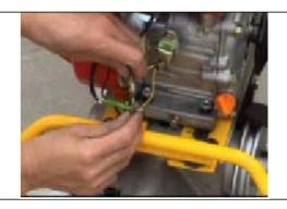
Прикрепите отключенный провод, который идет от выключателя, используя соединитель проводов, который расположен на нижнем блоке (рядом с выключателем двигателя).
