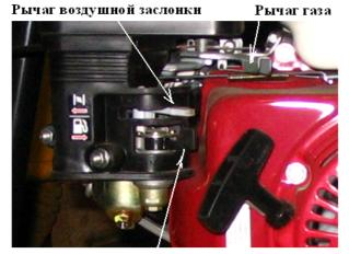
Краник топливного бака
