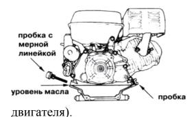
проверьте уровень масла картере В двигателя. Уровень масла определяется по мерной линейке на пробке заливного отверстия картера двигателя (двигатель должен быть установлен строго горизонтально). При незавернутой пробке уровень должен находиться в насеченной масла указателя (C<sub>M</sub>. Инструкцию ПО эксплуатации
