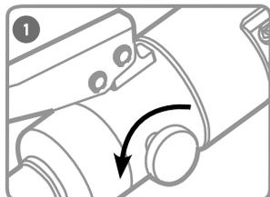
1 Поверните винт сброса давления в положение «Открыть»
