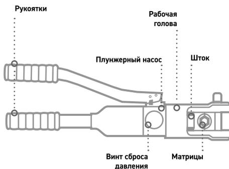
**!** Матрицы в комплекте инструмента не относятся к какому-либо конкретному стандарту, а имеют усредненные размеры профиля обжима, с возможностью применения к арматуре распространенных стандартов: ГОСТ, DIN, КВТ. Для применения к арматуре ГОСТ ниже приведены таблицы по выбору матрицы.
