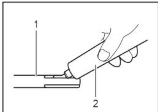
1. Головка хвостовика 2. Смазка
