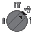
Pozycja Vario-Lock do zmiany ustawienia pozycji dłuta W tej pozycji przełącznik wiercenia udarowego/blokady obrotów 13 nie zaryglowuje się.
