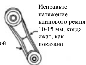
Рисунок 2. Натяжение клинового ремня
