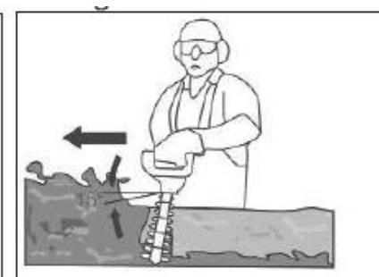
6. Не используйте кусторез для обрезки слишком крупных веток. Их следует срезать вручную с помощью секатора или ножниц.
