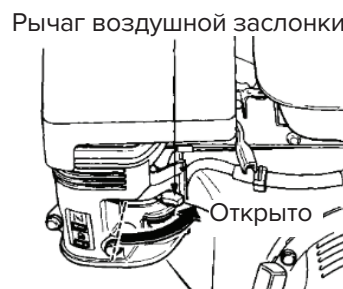
Рис. 10. Рычаг воздушной заслонки (открыто)
