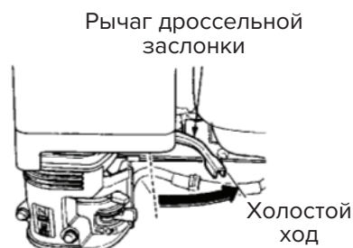
Рис. 15. Рычаг дроссельной заслонки (холостой ход)
