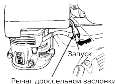
Рис. 14. Рычаг дроссельной заслонки (запуск)
