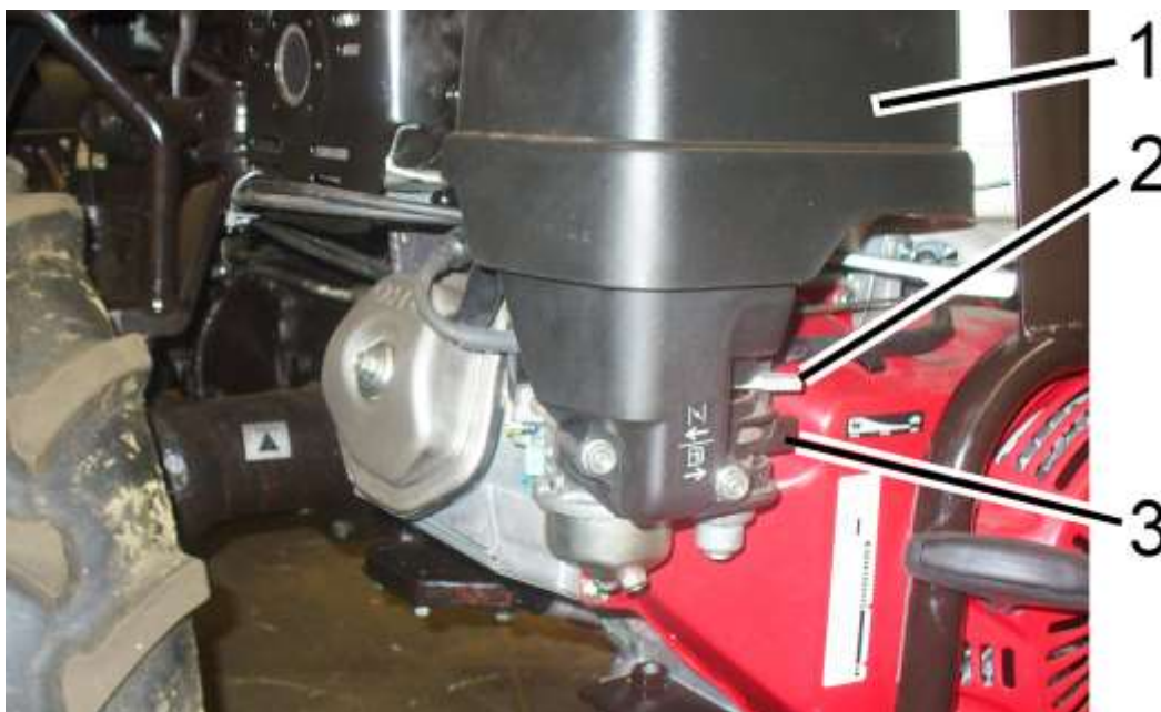
Рисунок 2.11 – Управление дроссельной заслонкой и краном топливного бака 1 – воздушный фильтр; 2 – рукоятка управления дроссельной заслонкой; 3 – рукоятка топливного крана
