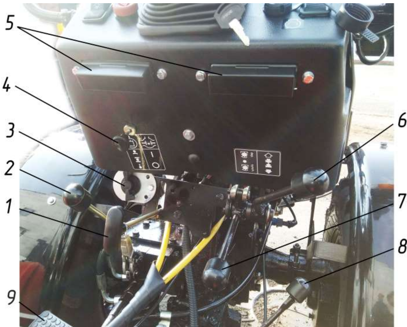
Рисунок 2.1.1 – Расположение органов управления мини-трактора
