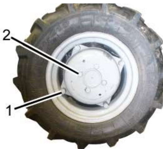
Рисунок 6.4.2 – Проверка затяжки резьбовых соединений крепления колес 1 – гайка крепления дисков колес к кронштейнам ободьев; 2 – болты крепления колес к фланцам
