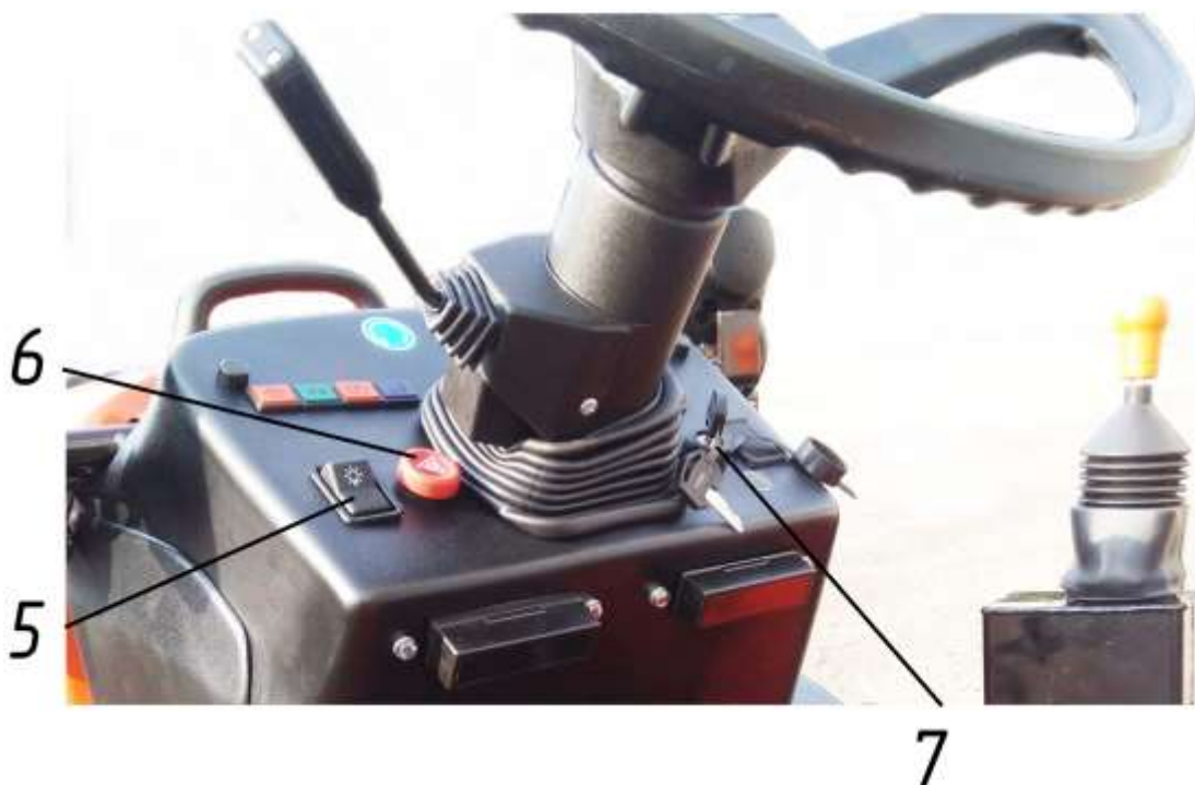
Рисунок 2.2.2 – Выключатели и переключатели щитка приборов 5 – центральный переключатель света; 6 – выключатель аварийной световой сигнализации; 7 – выключатель стартера и приборов
