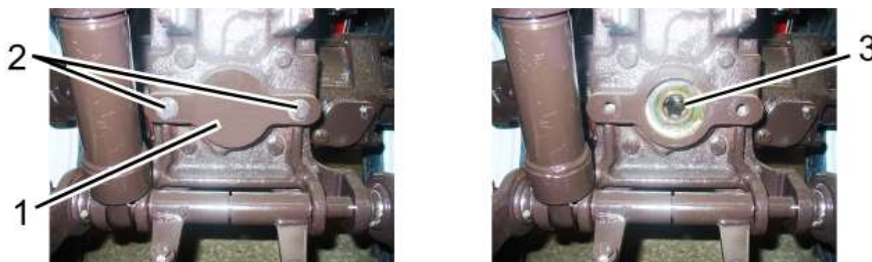
Рисунок 4.2 – Снятие защитного колпака и замена хвостовика заднего ВОМ 1 – защитная пластина; 2 – болты; 3 – хвостовик ВОМ
