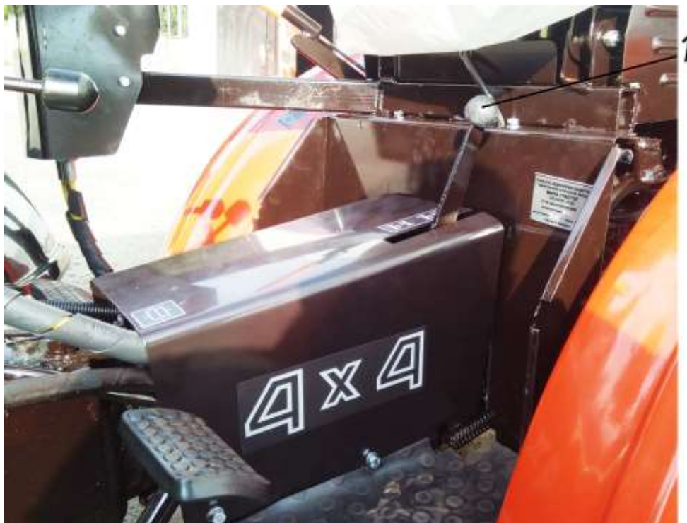
Рисунок 2.6 – Управление приводом заднего моста 1 – рукоятка управления приводом заднего моста
