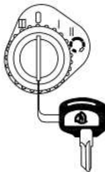
Рисунок 2.2.3 – Схема положений выключателя стартера и приборов
