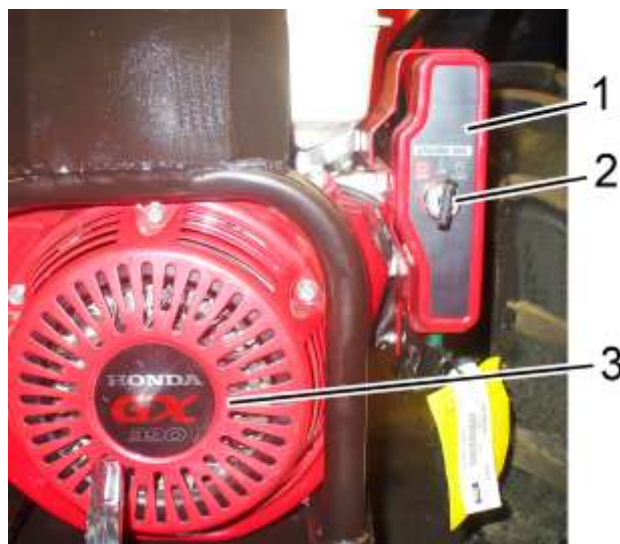
Рисунок 2.2.4 – Выключатель стартера, расположенный на двигателе 1 – пульт; 2 – выключатель стартера; 3 – двигатель
