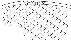
Проверяйте абразивный диск, подвесив его на пальце и слегка ударив по нему ручкой отвертки или другим подобным предметом. Если звук диска не дает полного звучания, значит диск поврежден.
