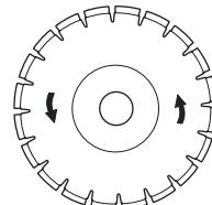
С задней стороны машины есть стрелка, показывающая направление вращения на оси крепления диска.
