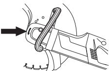
При замене режущего диска на новый, проверяйте фланцевые шайбы и ведущую ось. Выполните указания в разделе Проверка ведущей оси и фланцевых шайб.
