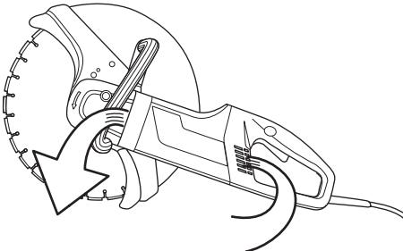
Чтобы машина всегда получала надлежащее охлаждение, сопла подачи холодного воздуха должны содержаться в чистоте и не должны быть ничем закрыты. Регулярно продувайте машину сжатым воздухом.
