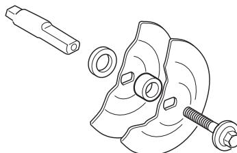
Не пользуйтесь фланцевыми шайбами с перекосом, со сбитыми краями, со следами ударов или грязными. Не пользуйтесь фланцевыми шайбами разных размеров.
