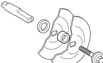
Не пользуйтесь фланцевыми шайбами с перекосом, со сбитыми краями, со следами ударов или грязными. Не пользуйтесь фланцевыми шайбами разных размеров.
