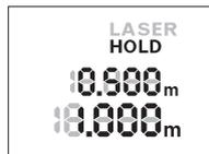
Pritisnite ponovno tipku „HOLD“ **2** kako biste ponovno zaustavili mjerenje. Laserska zraka se isključuje i pokazatelj **HOLD** se pojavljuje na displeju. U gornjem retku se prikazuje prethodna mjerena vrijednost. U donjem retku se prikazuje aktualna mjerna vrijednost ali se više stalno ne aktualizira.
