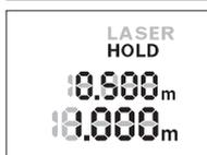
Wcisnąć przycisk „HOLD” **2** po raz wtóry, aby ponownie zatrzymać pomiar. Wiązka laserowa jest wyłączana, a wskaźnik **HOLD** pojawia się na wyświetlaczu. W górnym pasku wyświetlana jest poprzednia wartość pomiarowa. W dolnym pasku wyświetlana jest aktualna wartość pomiarowa, ale nie jest ona stale aktualizowana.
