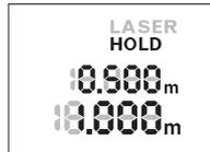
Apăsăți din nou tasta „HOLD” **2** pentru a bloca din nou procesul de măsurare. Raza laser se deconectează iar pe display apare indicatorul **HOLD**. Pe rândul de sus va fi afișată valoarea anterioară măsurată. Valoarea curentă măsurată va continua să fie afișată pe rândul de jos al displayului, dar nu va mai fi actualizată continuu.
