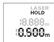
Mõõtmise peatamiseks vajutage „HOLD“-nupule **2**. Laserkiir lülitub välja ja näit **HOLD** ilmub ekraanile. Aktuaalset mõõtetulemust kuvatakse endiselt ekraani alumisel real, kuid seda ei ajakohastata pidevalt.
