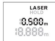
Apăsați din nou tasta „HOLD“ **2**, pentru a reconecta laserul. Indicatorul **LASER** clipește pe display. Pe rândul de sus va fi afișată valoarea anterioară măsurată. Pe rândul de jos va fi afișată valoarea curentă măsurată/actualizată continuu.
