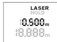
Ще раз натисніть на кнопку «HOLD» **2**, щоб знову увімкнути лазер. Надпис **LASER** мигає на дисплеї. У верхньому рядку відображається попередній результат вимірювання. В нижньому рядку відображається постійно актуалізований/актуальний результат вимірювання.
