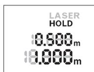
Чтобы еще раз остановить измерение, нажмите на кнопку «HOLD» **2**. Лазерный луч выключается, и на дисплее отображается надпись **HOLD**. В верхней строке отображается предыдущий результат измерения. В нижней строке отображается актуальный результат измерения, но он уже не актуализируется постоянно.
