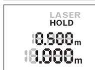
Pokud znovu stisknete tlačítko „HOLD“ 2, opět zastavíte měření. Laserový paprsek se vypne a na displeji se zobrazí **HOLD**. V horním řádku se zobrazí předchozí naměřená hodnota. Ve spodním řádku se zobrazuje aktuální naměřená hodnota, která se již neaktualizuje.
