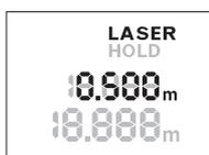
Wcisnąć przycisk „HOLD” **2**, aby ponownie włączyć laser. Wskaźnik **LASER** miga na wyświetlaczu. W górnym pasku wyświetlana jest poprzednia wartość pomiarowa. W dolnym pasku wyświetlana jest aktualna/aktualizowana wartość pomiarowa.
