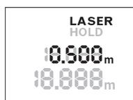
Натиснете повторно бутона «HOLD» **2**, за да включите отново лазерния лъч. На дисплея започва да мига символът **LASER**. На горния ред на дисплея се изобразява предходно измерената стойност. На долния ред на дисплея се изобразява/актуализира текущо измерената стойност.
