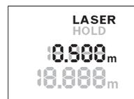
Nyomja meg ismét a **2** „HOLD” gombot, hogy ismét bekapcsolja a lézert. A kijelzőn villog a **LASER** kijelzés. A felső sorban megjelenik az előző mérési eredmény. Az alsó sorban a folyamatosan frissített/aktuális mérési eredmény kerül kijelzésre.
