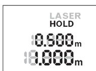
Ja no jauna vēlaties apturēt mērīšanas procesu, vēlreiz nospiediet mērījuma rezultāta fiksēšanas taustiņu „HOLD” **2**. Pie tam izslēdzas lāzera stars, un uz displeja parādās mērījuma rezultāta fiksēšanas indikators **HOLD**. Displeja augšējā rindā tiek parādīts iepriekšējā mērījuma rezultāts. Displeja apakšējā rindā joprojām
