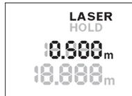
Na opätovné zapnutie lasera opäť stlačte tlačidlo „HOLD“ **2**. Na displeji bliká nápis **LASER**. V hornom riadku sa zobrazí predchádzajúca nameraná hodnota. V dolnom riadku sa bude stále zobrazovať aktualizovaná/aktuálne nameraná hodnota.
