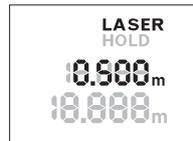
Lai no jauna ieslēgtu lāzera, vēlreiz nospiediet mērījuma rezultāta fiksēšanas taustiņu „HOLD“ **2**. Uz displeja sāk mirgot lāzera ieslēgšanas indikators **LASER**. Displeja augšējā rindā tiek parādīts iepriekšējā mērījuma rezultāts. Displeja apakšējā rindā tiek parādīts aktuālais mērīšanas rezultāts, kas tiek periodiski atjaunots.
