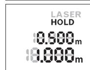
Mõõtmise veelkordseks peatamiseks vajutage uuesti „HOLD“-nupule **2**. Laserkiir lülitub välja ja näit **HOLD** ilmub ekraanile. Ülemisel real kuvatakse eelmist mõõtetulemust. Alumisel real kuvatakse aktuaalset mõõtetulemust, kuid seda ei ajakohastata pidevalt.
