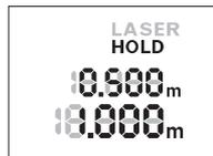
Nyomja meg ismét a **2** „HOLD” gombot, hogy ismét megállítsa a mérési eljárást. A lézersugár kikapcsolásra kerül és a kijelzőn megjelenik a **HOLD** kijelzés. A felső sorban megjelenik az előző mérési eredmény. Az alsó sorban az aktuális mérési eredmény látható, de az most már nem kerül folytonosan frissítésre.
