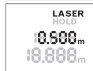
Et laserit uuesti sisse lülitada, vajutage taas „HOLD“-nupule **2**. Näit **LASER** vilgub ekraanil. Ülemisel real kuvatakse eelmist mõõtetulemust. Alumisel real kuvatakse pidevalt ajakohastatud/aktuaalset mõõtetulemust.
