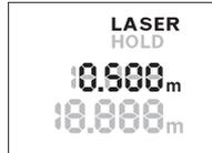
Pritisnite ponovno tipku „HOLD“ **2** za ponovno uključivanje lasera. Pokazatelj **LASER** treperi na displeju. U gornjem retku se prikazuje prethodna mjerena vrijednost. U donjem retku se stalno prikazuje aktualizirana/aktualna mjerna vrijednost.
