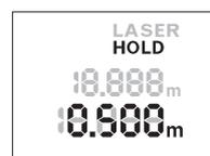
Wcisnąć przycisk „HOLD” **2**, aby zatrzymać pomiar. Wiązka laserowa jest wyłączana, a wskaźnik **HOLD** pojawia się na wyświetlaczu. Aktualna wartość pomiarowa wyświetlana jest w dalszym ciągu w dolnym pasku wyświetlacza, ale nie jest stale aktualizowana.
