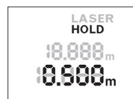
Натисніть на кнопку «HOLD» **2**, щоб зупинити вимірювання. Лазерний промінь вимикається, і на дисплеї з'являється надпис **HOLD**. Актуальний результат вимірювання продовжує відображатися в нижньому рядку дисплея, але більше не актуалізується.
