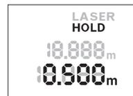
A mérési eljárás leállításához nyomja meg a **2** „HOLD” gombot. A lézersugár kikapcsolásra kerül és a kijelzőn megjelenik a **HOLD** kijelzés. Az aktuális mérési eredmény továbbra is a kijelző legalsó sorában jelenik meg, de már nem kerül folytonosan frissítésre.
