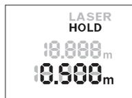
Stisknutím tlačítka „HOLD“ **2** zastavíte měření. Laserový paprsek se vypne a na displeji se zobrazí **HOLD**. Ve spodním řádku na displeji se nadále zobrazuje aktuální naměřená hodnota, která se již neaktualizuje.
