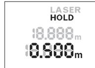
Lai apturētu mērīšanas procesu, nospiediet mērījuma rezultāta fiksēšanas taustiņu „HOLD“ **2**. Pie tam izslēdzas lāzera stars, un uz displeja parādās mērījuma rezultāta fiksēšanas indikators **HOLD**. Displeja apakšējā rindā joprojām ir redzams aktuālais mērīšanas rezultāts, taču tas vairs nemainās, jo netiek periodiski atjaunots.
