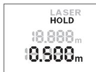
Нажмите на кнопку «HOLD» **2**, чтобы остановить измерение. Лазерный луч выключается, и на дисплее отображается **HOLD**. Актуальный результат измерения по-прежнему отображается в нижней строке дисплея, но не обновляется постоянно.
