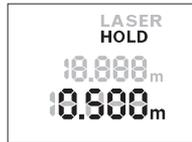
Өлшеу әдісін тоқтату үшін „HOLD“ түймешесін басыңыз **2**. Лазер өшіп дисплейде **HOLD** индикаторы жанады. Ағымдық өлшеу көлемі дисплейдің төмен қатарында көрсетіледі, бірақ жаңартылмайды.
