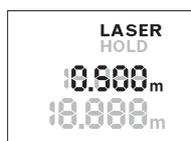
Opakovaným stisknutím tlačítka „HOLD“ 2 znovu zapnete laser. Na displeji bliká nápis **LASER**. V horním řádku se zobrazí předchozí naměřená hodnota. Ve spodním řádku na displeji se nepřetržitě zobrazuje aktualizovaná/aktuální naměřená hodnota.
