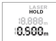
Če želite merjenje začasno prekiniti, pritisnite tipko „HOLD“ **2**. Laserski žarek se izključi in na prikazovalniku se prikaže **HOLD**. Trenutna izmerjena vrednost je še naprej prikazana v spodnji vrstici prikazovalnika, vendar se več ne posodablja.
