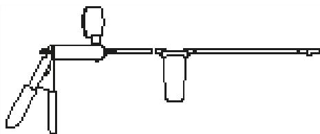
Свободный конец шланга соедините со штуцером рабочего (исполняющего) цилиндра. Шприцом создайте разряжение в ёмкости. Ключом для прокачки отверните штуцер рабочего цилиндра и дождитесь однородного поступления жидкости без воздушных пробок из гидравлической системы
