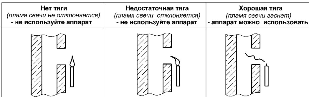
Рис. 4. Способ проверки тяги в дымоходе
