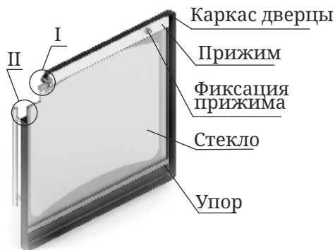
Рисунок 19. Ремонт светопрозрачного экрана дверцы модификации «Витра»
