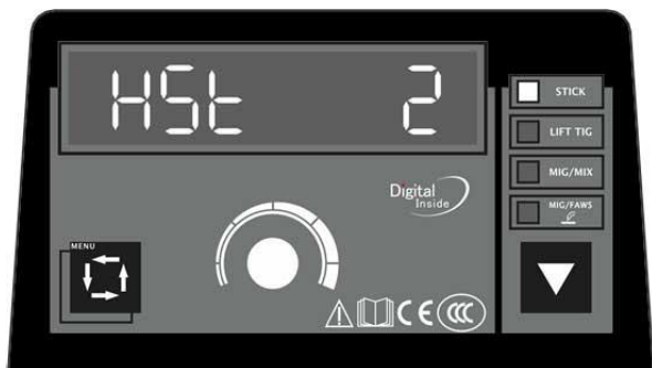
Рисунок 3. Установка времени горячего старта. Диапазон 0.2~2 сек.
