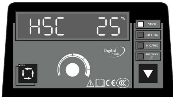
Рисунок 2. Установка тока горячего старта. Диапазон 0 ~ 50%
