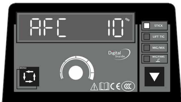
Рисунок 4. Установка форсажа дуги. Диапазон 0–80%
