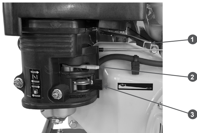
Рис. 4. Основные узлы и органы управления (вид со стороны стартера)
