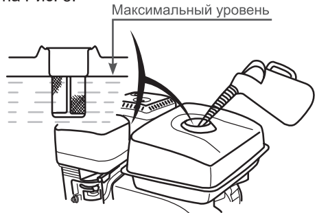
Рис. 8. Максимальный уровень топлива в топливном баке
