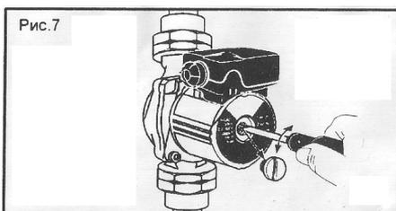
Если насос не запускается, устранить блокировку (рис.7). Блокировка может быть вызвана длительным простоем насоса либо попаданием примесей в воду.
